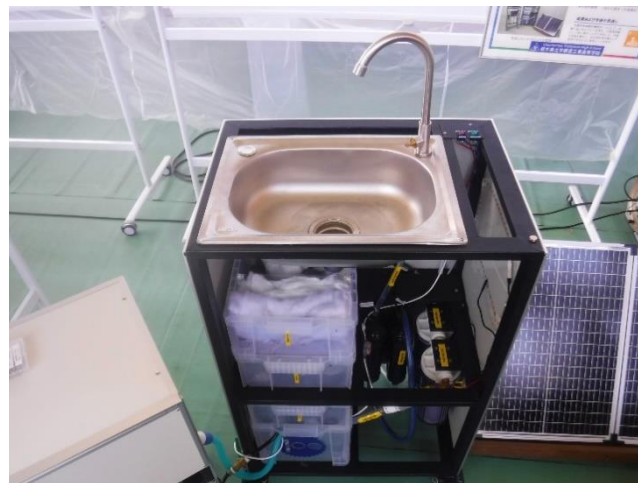
製作した小型浄水器
