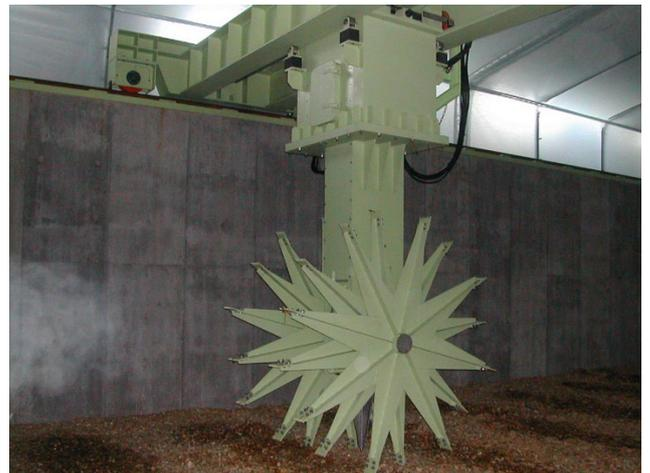
写真 2：パドル式攪拌装置
